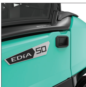
Accès facile et rapide à la prise batterie
